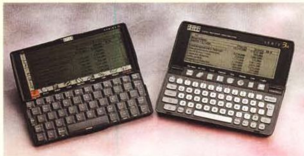
A confronto il display del Series 5 con quello del precedente 3a. La visibilità è peggiorata, tutta colpa del touch screen e del pannello backlite.
